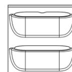
**Kasety:** przednia część kaset jest wykonana z przepuszczającego powietrze spienionego polipropylenu (EPP). Tył jest wykonany z polipropylenu (PP). Kasety są wypełnione kapilarnym mikrowłóknem tekstylnym wykonanym w 80% z poliestru i 20% z poliamidu. Wszystkie materiały mogą być ponownie wykorzystane i w pełni nadają się do recyklingu.
